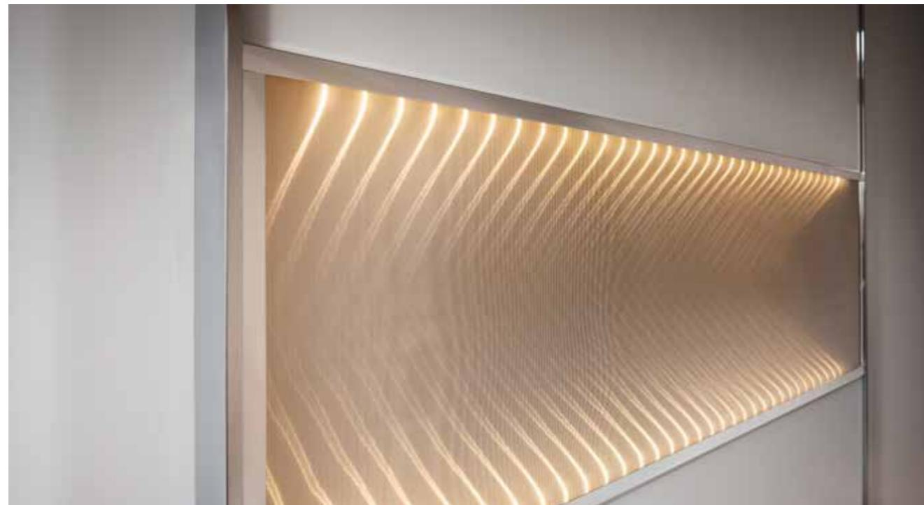
Das Geheimnis der 3D-Ambientebeleuchtung liegt in der Beschaffenheit des Textilgewebes unter der Glasplatte. Durch die Interaktion des Spezialgewebes mit punktförmigen LEDs wird eine dreidimensionale Lichtstruktur erzeugt.
